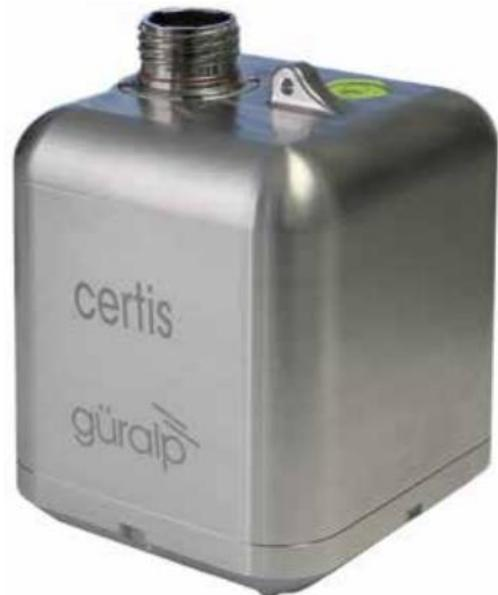
▲ Режим сверхнизкого энергопотребления позволяет потреблять менее чем 250 мВт, используя портативный модуль питания, который можно повторно заряжать с помощью солнечных панелей.
