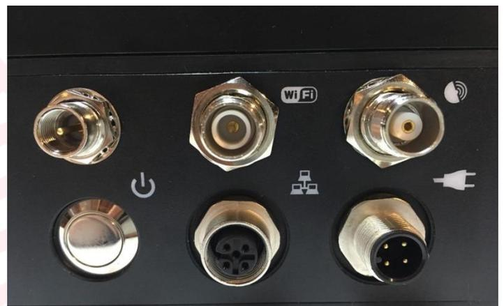
Регистратор Апатит отлично адаптирован к полевой эксплуатации. WEB-интерфейс позволяет легко конфигурировать сейсмостанции и объединять их в многоканальные системы. Встроенный аккумулятор совместно с внешним контроллером заряда способен полностью автономно питать регистратор от солнечной батареи без дополнительных источников питания при энергопотреблении менее 2 Вт.
