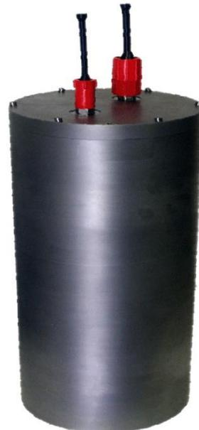
«Куприт posthole» не требует арретирования, центрирования массы или специального оборудования для процедуры установки. Велосиметр имеет низкое энергопотребление, работает в широком температурном диапазоне. Может быть погружен на глубину до 350 м и останется работоспособным в широком диапазоне монтажных наклонов.
